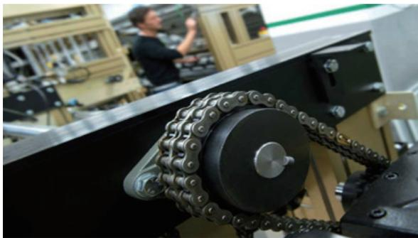
图2-传统的机械产线由链条或皮带传输
