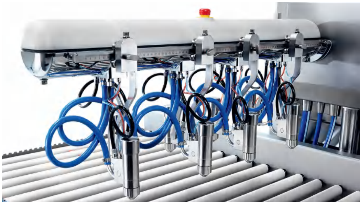
Octopus机器拥有两个机械臂，每个臂最多有八个喷头。用户在设置机器时，可以决定他们想要使用多少个喷头。
