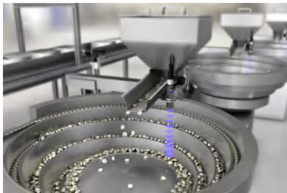
图3:全新UR18超声波传感器的声束角可灵活调节为小、中、大三个级别。如果需要测量散装物料的物位，例如测量振动给料机中的螺钉，大声束角更适合，因为如果声束角变大，反射声束的方向即使很偏也能可靠检测到。
