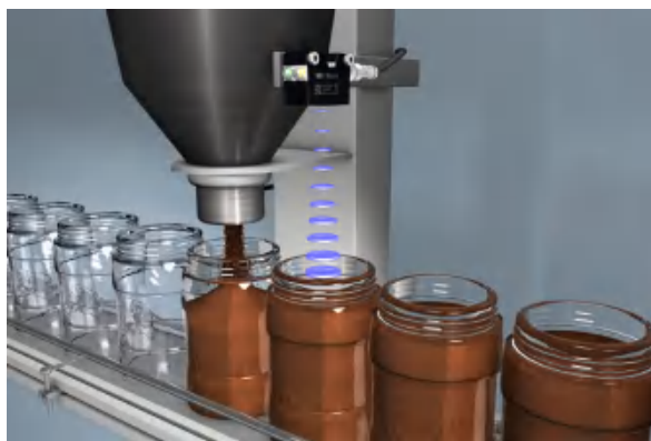
图2:堡盟新款UR18超声波传感器可根据容器开口大小和填充介质类型现场调节声束角大小。如要通过狭小开口进行物位测量，则需使用小声束角。
