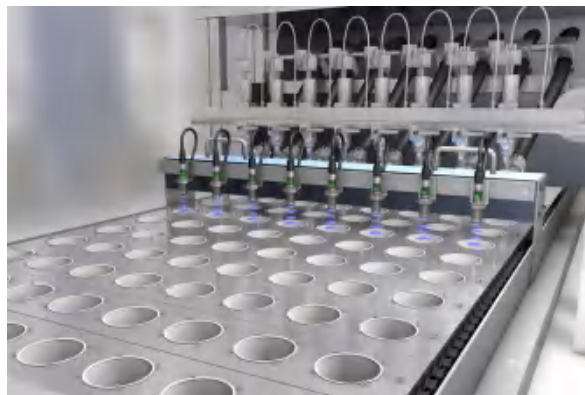
图4:凭借同步功能，UR18超声波传感器即便多个紧靠着并排安装，也能同时进行操作，且没有任何干扰。这意味着相邻传感器的声束角不会互相影响。通过外部脉冲或通过IO-Link发出指令，便可触发同步功能。
