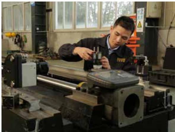
厦门大金机械有限公司多年来一直对机床质量有严格的管控, 他们最先选用雷尼绍XK10激光校准仪以此提升整体检测效率, 以及有效降低人工成本。
