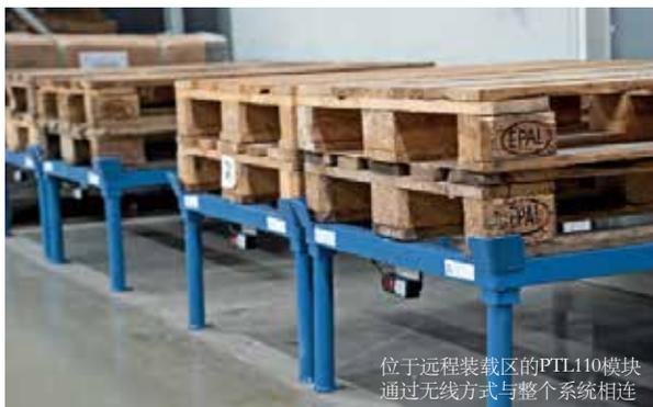
位于远程装载区的PTL110模块通过无线方式与整个系统相连
