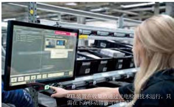
PTL装置在收集点通过光电检测技术运行，只需在下方移动脚即可进行确认
