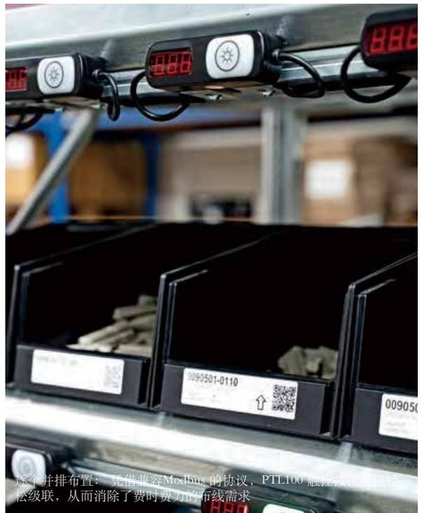
指示通往对应移除点的路径。这样，一旦拾取被确认，就会点亮绿灯，且会短暂闪烁黄灯。装载区会进行不同的过程，其中托盘放置在低位，而PTL设备则安装在与头齐平的高度。“该创意源自于某些车辆的后备箱门可以通过脚来打开。” Hannesen回忆道。KEB工程师因此为其收集点选择采用非接触式检测原理的PTL模块。员工现在可以小心使用双手将包装放下，并只需将脚伸到光电传感器下方即可进行确认。
