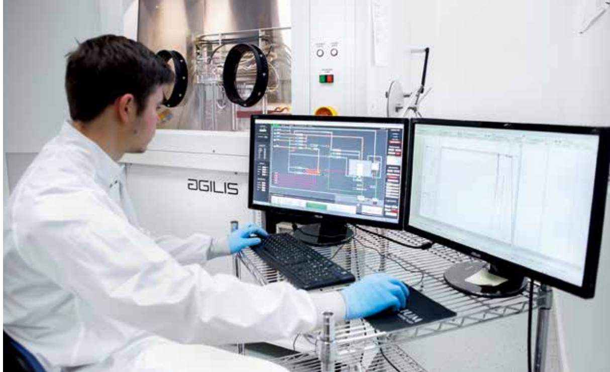
Agnitron 的 Imperium-MOCVD™ 软件基于 TwinCAT 3 自动化软件构建，让工程师能够通过 Microsoft Visual Studio® 使用 C# 语言编程机器逻辑
