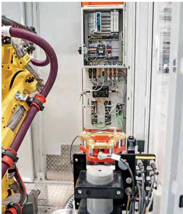
该安全应用由TBP（左）控制，用于工厂中的测试。Profisafe控制器则在最终客户侧接管应用的实际运行。所有连接至IO-Link master（中）的执行器都通过TBSBox进行安全关断
