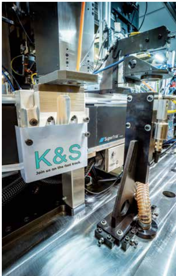
SuperTrak可以分别定义每个滑块是否以及如何通过每个加工工位。
