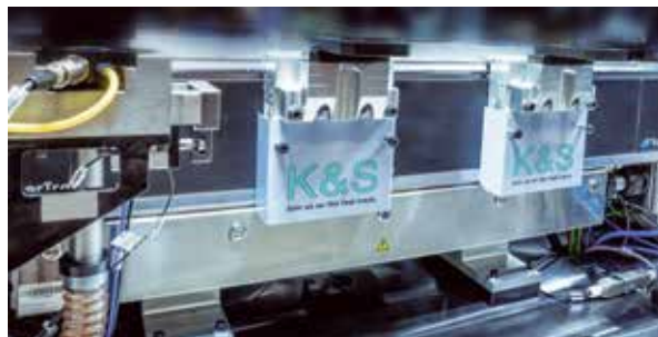
装在滑块上的工件输送架可实现独立控制，这使装配线具有高柔性。
