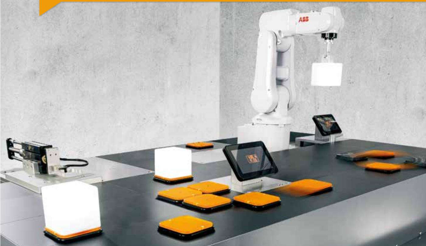
ACOPOS 6D让您在开放的制造空间中自由地移动产品 - 不受一维生产流程的限制。磁悬浮技术提供了六个自由度，可在较小占地面积上实现前所未有的加工密度。
