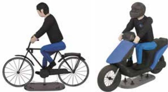
现有的被动措施正在通过主动保护行人得到加强。在4activeSystems，使用逼真的汽车假人来测试防碰撞系统。
