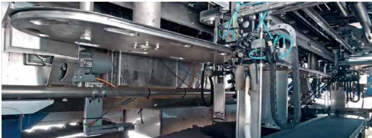
机器上布置了6到12个收获模块，控制器利用传感器的数据使这些模块运行到正确位置
