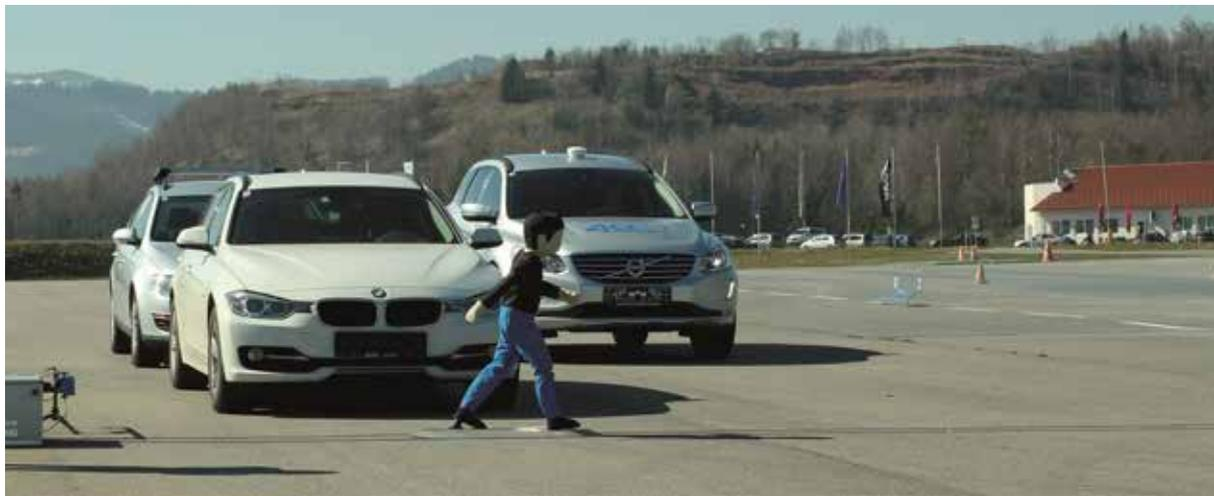
在涉及到机动车的碰撞中，通常是行人和骑自行车者付出的代价最高。超过90%的交通事故是由人为过失造成的，其后果往往是致命的。4activeSystems公司由4a技术集团成立于2014年，专注于车辆主动安全技术。在位于奥地利Traboch的工厂中，他们一直在开发和制造移动式 and 固定式AEB（自动紧急制动）测试设备，以及用于测试预测性防碰撞系统的碰撞试验假人。贝加莱从一开始就被选中作为首选的自动化组件供应商。
