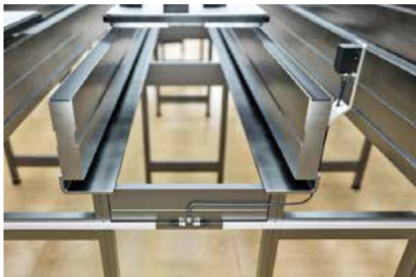
每个输送线都配有支持Bus Mode模式的读写头，它们可利用T型分线器轻松安装在线性拓扑结构中
