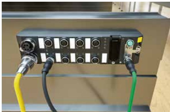
每个接口模块拥有4个RFID通道，每个RFID通道可连接多达32个读写头，因此每个接口模块可连接多达128个读写头
