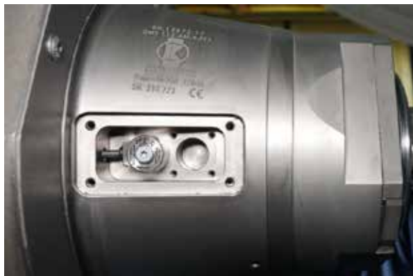
持续监测：ifm的VSA004型振动传感器直接安装在主轴上
