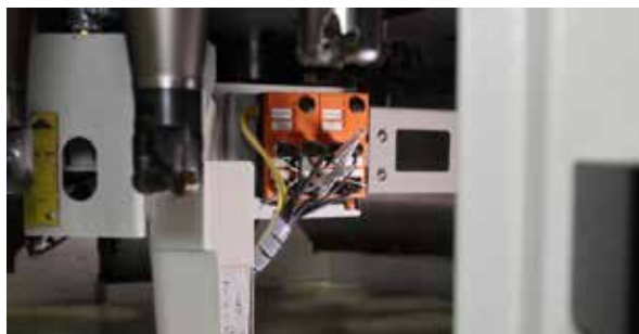
减少布线：AS-i模块采集传感器数据并通过两线制总线电缆将其传输至控制器
