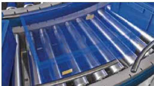
RFID载码体沿对角线布置，可确保至少1个载码体位于读写器的检测范围内，保证始终稳定的读取效果。
